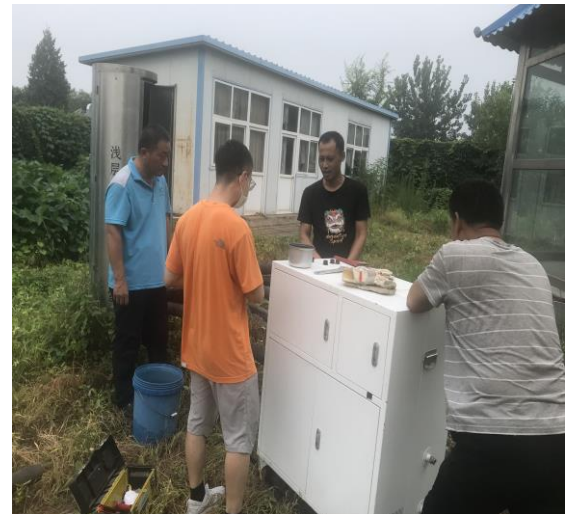
岩土热响应测试施工
