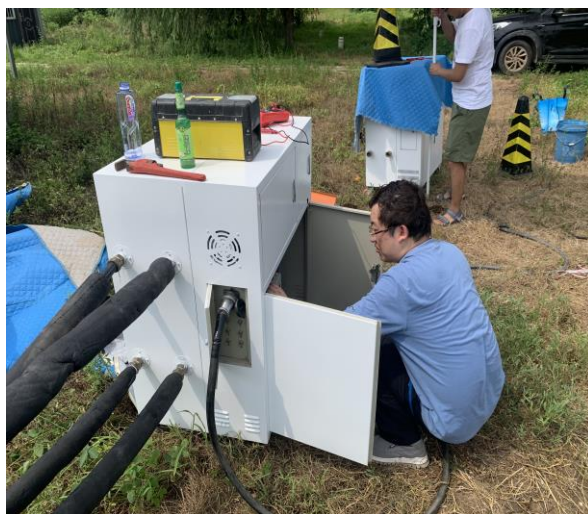
岩土热响应测试施工
