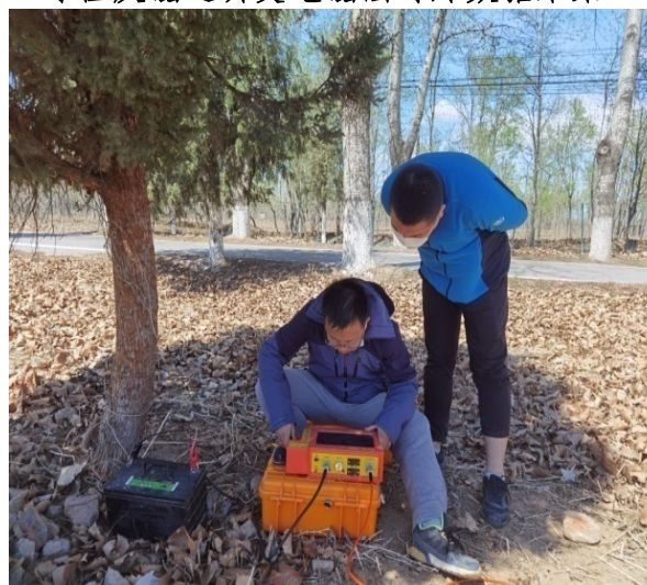
三维高密度电阻率法野外数据采集
