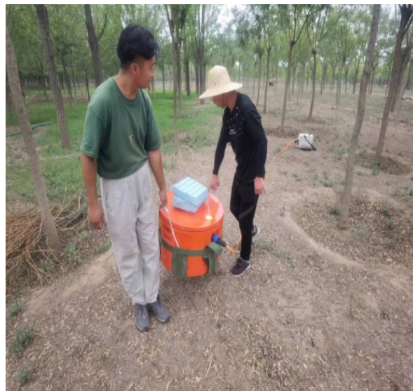
等值反磁通瞬变电磁法野外数据采集
