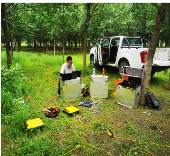
三维地震折射层析成像法野外数据采集
