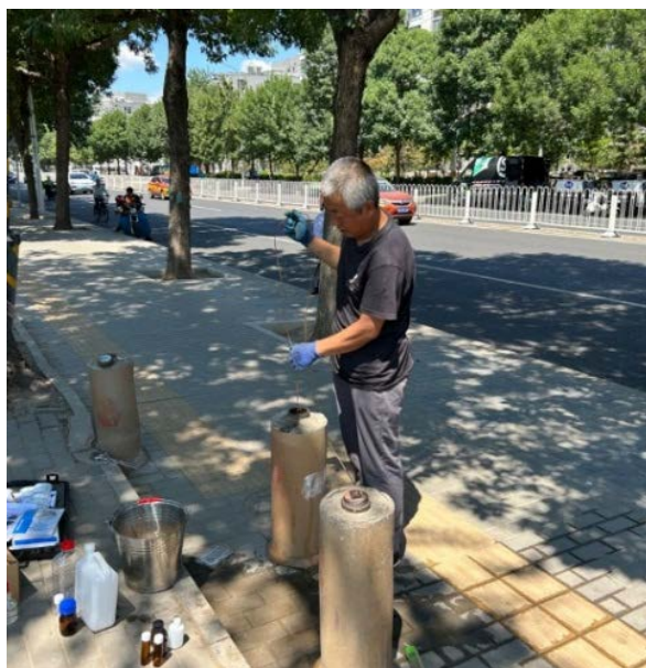
监测井野外复核及水位核测工作
